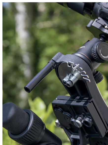
▲ Abb. 2: Die Polsucher-Peilhilfe und die mehrstufige Federkonstruktion zum Ausgleich von Ungleichgewichten.
