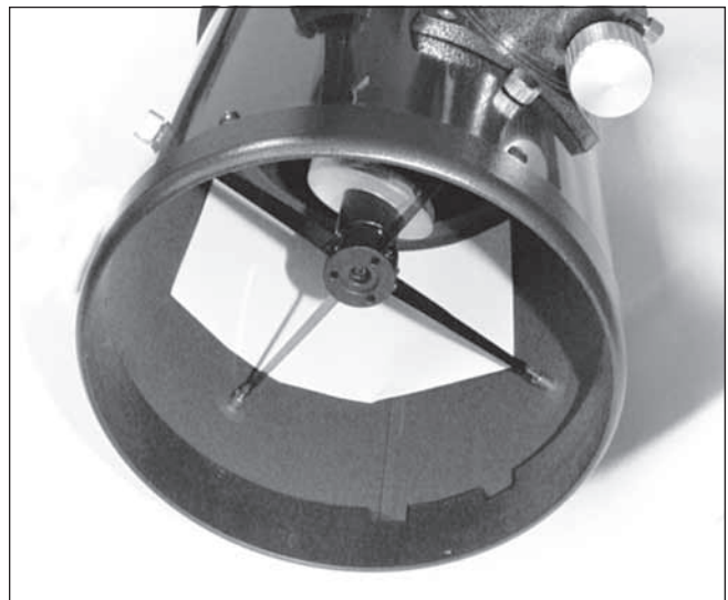
Figure 10. Pour obtenir un fond lumineux lorsque vous regardez dans le porte-oculaire, placez un morceau de papier blanc à l'intérieur du tube optique, en regard du porte-oculaire.
