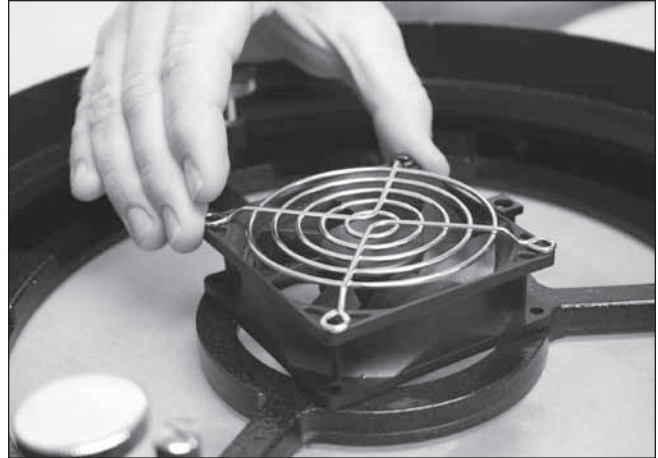
Figure 4a. Alignez les trous du ventilateur et de son couvercle avec les trous se trouvant à l'arrière de la cellule du miroir primaire.
