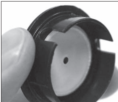
Abbildung 12. Die Schnellkollimationskappe, die über eine reflektierende Innenfläche verfügt, hilft während der Kollimation beim Zentrieren der Reflexionen der Optik zum Fokussierer.
