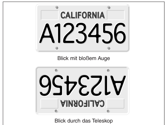
Abbildung 8. Beim Blick durch ein Spiegelteleskop ist das sichtbare Bild um 180° gedreht.
