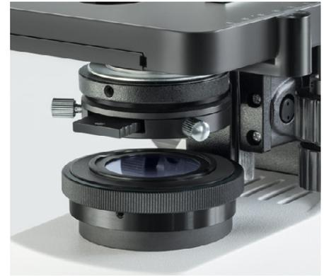
Condenseur de contraste de phase monté
