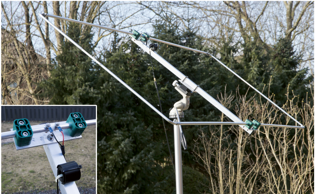
Abbildung 9.19 Moxon-Antenne für 50 MHz (Fa. WiMo) mit selbstgewickelter Drosselspule aus einem Koaxkabel vom Typ RG-174. Für die Montage auf einem Stativ wurde eine Prismenschiene aus PLA mit einem 3D-Drucker hergestellt.
